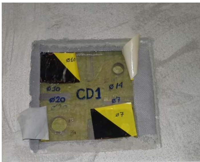
Figur 5. Blændeskive placeret i oversidemembran. De enkelte huller kan blændes med tape, hvorved forskellige kombinationer af åbninger kan skabes.
