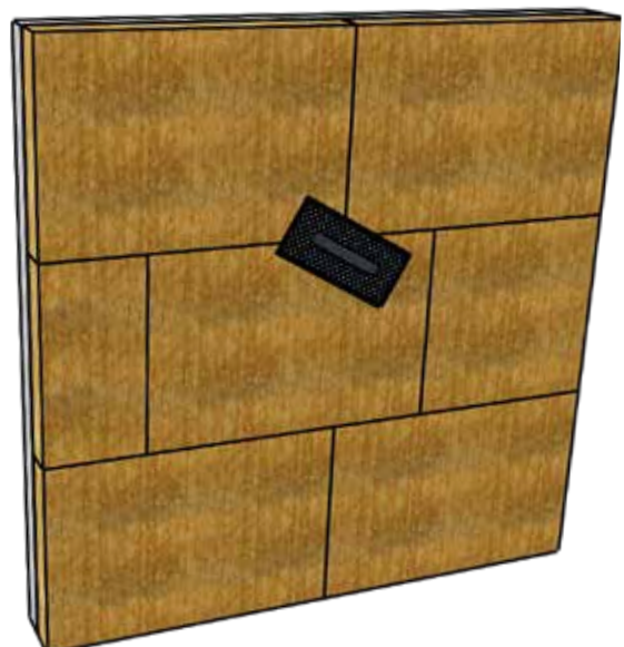
▶ Ojämnheter på ytan kan åtgäras med rivbräda
