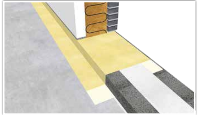
▶ Yttervägg/fundament med markbeläggning på lägre höjd än sockelns övre del.
