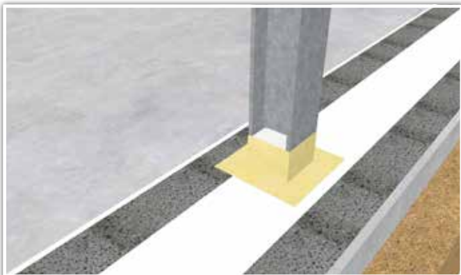
► 4 st färdiga LIP ÅT-ytterhörn limmas med LIP 2K Folielim.
