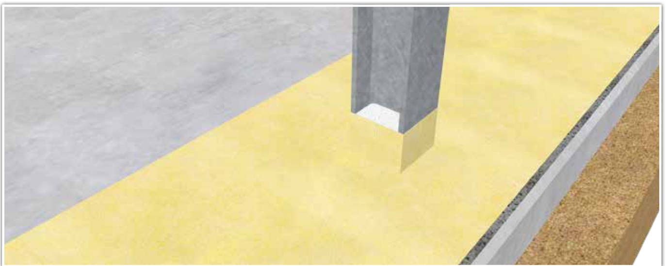
► Radonskydd vid pelare i hålvägg.
