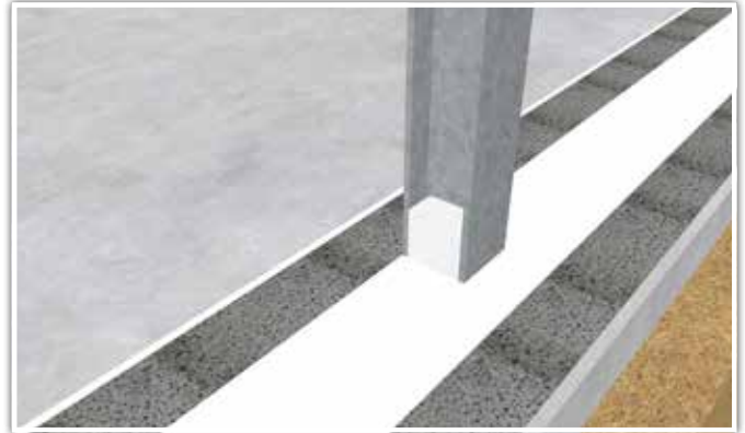
► EPS-blocket formas och limmas helt med LIP 2K Folielim.
