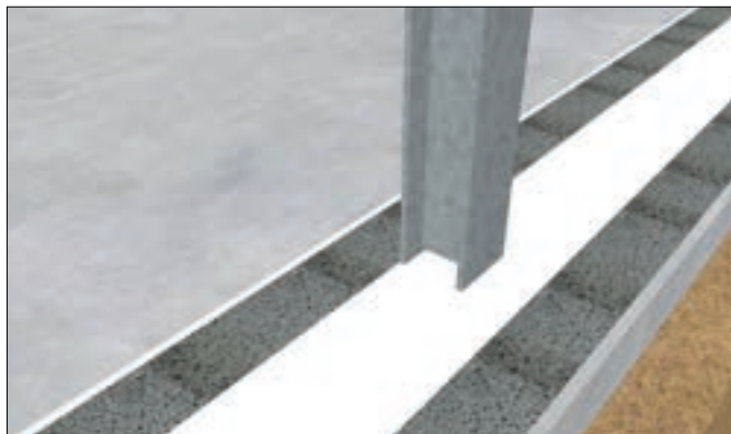
► HEB-spackel i hålvägg.
