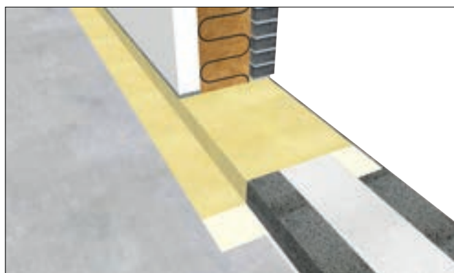
► Yttervägg/fundament med markbeläggning på lägre höjd än sockelns övre del.
