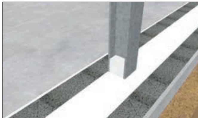
► EPS-blocket formas och limmas helt med LIP 2K Folielim.
