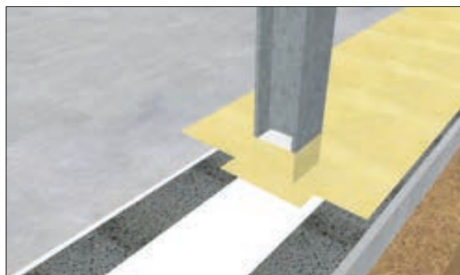
► LIP Folie formas och monteras med LIP 2K Folielim.
