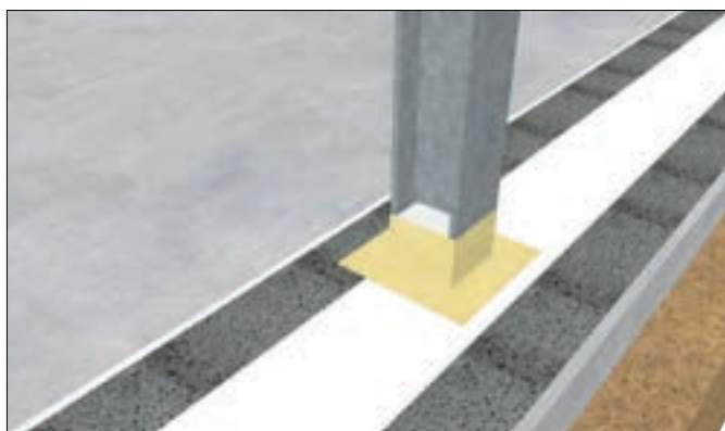
► 4 st färdiga LIP AT-ytterhorn limmas med LIP 2K Folielim.
